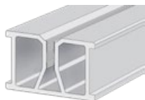
legar aluminiowy niski - rozstaw podpór max. co 60 cm
